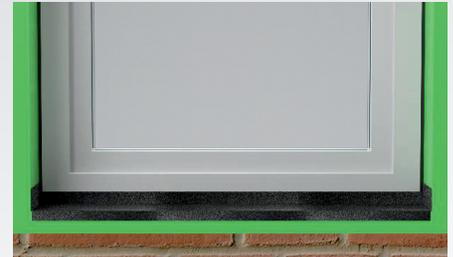
3. Das vliesfreie Band auf den Bereich der Fensterbank kleben (mit Überlappung auf den Innenecken sowie dem Fensterrahmen).
