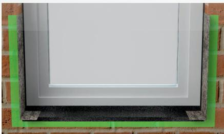
4. Das Dichtband mit Dehnlies zuschneiden und überlappend mit den Innenecken auf die Laibung kleben.
