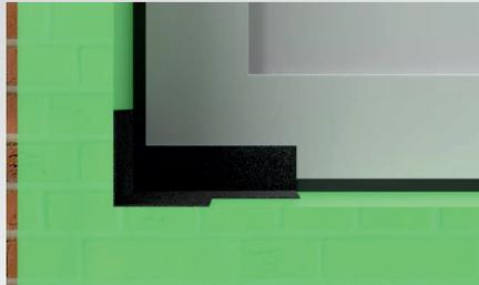
2. Innenecken für die Einbausituation zuschneiden dann auf Fensterbank, Laibung und Fensterrahmen kleben und andrücken.
