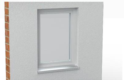
6. Fensterbank gemäß Anleitung montieren und die Wände verputzen.
