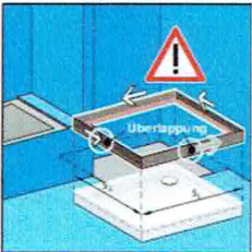
A10. Bodenebenen Einbau / Überlappung nur auf Längsseite! Duschwanne ausmessen (1+2) x2, Wannensabdichtung ansetzen und umlaufend ankleben. Falls eine Verlängerung erforderlich ist, kann die Wannensabdichtung auf den Längsseiten überlappend angesetzt werden.
