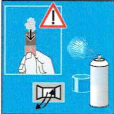
A3. Wenn der Klebewersuch negativ ausfällt, kann der Sprühprimer herangezogen werden. Sprühprimer bei geöffnetem Fenster oder Tür im Abstand von 20-40 cm leicht aufsprühen. (Verarbeitungshinweise des Herstellers beachten!) Neu! Handwerkerfreundliches Primern (10 min. Trocknungszeit).
