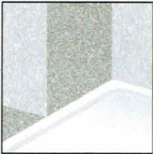
F1. Fertige Verbundabdichtung trocken verklebt Wanne und Wand/Boden.
