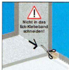
C13. Anschließend mit dem der Schere die Dichtbahn entlang der Markierung sauber abschneiden. Vorsicht! Eckklebeband nicht beschädigen!
