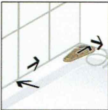
F3. Schnittfesten Fugenfüller zwischen Fliese und Wanne anbringen.
