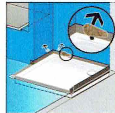
A 24. Nach Entfernen aller Schutzfolien wird die Wannendichtung sowie die verbleibenden Ecken 1 bis 3 an Boden und Wand mit Rakei (Bild 22) angedrückt. Dabei von unten nach oben streichen.
