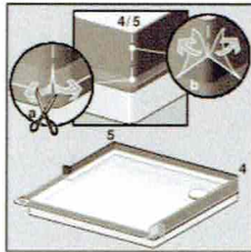
A 20. Die Ecken 4 und 5 müssen von unten an der Kante der Anfallschleife der Abdeckfolie ca. 10 mm nach oben eingeschnitten werden (a). Danach die Folie nach oben aufreißen (b).
